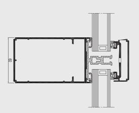
Concept Roof® 120 è il sistema a taglio termico per verande e coperture tetti che offre una vasta gamma di stili e configurazioni.
