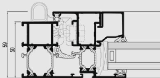
**Eco system** è un sistema per serramenti ad alto rendimento energetico. Con un valore  $U_f$  superiore a  $2.20 \text{ W/m}^2\text{K}$ , questo sistema soddisfa le richieste più esigenti.
