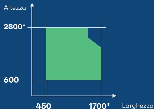
\*Le dimensioni massime dipendono da molteplici parametri, inclusi i requisiti di carico del vento e la scelta del tipo di vetro.
