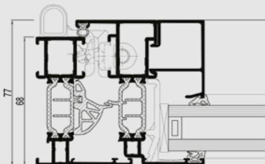
Concept System® 77 è il sistema ad elevato isolamento per finestre e porte che soddisfa elevati requisiti in termini di isolamento termico, stabilità e sicurezza. La variante di sistema HI+ raggiunge valori  $U_f$  fino a  $1.2 \text{ W/m}^2\text{K}$ , mentre il valore  $U_f$  di una sezione standard telaio/anta con larghezza visibile pari a 115 mm è  $1.7 \text{ W/m}^2\text{K}$ .
